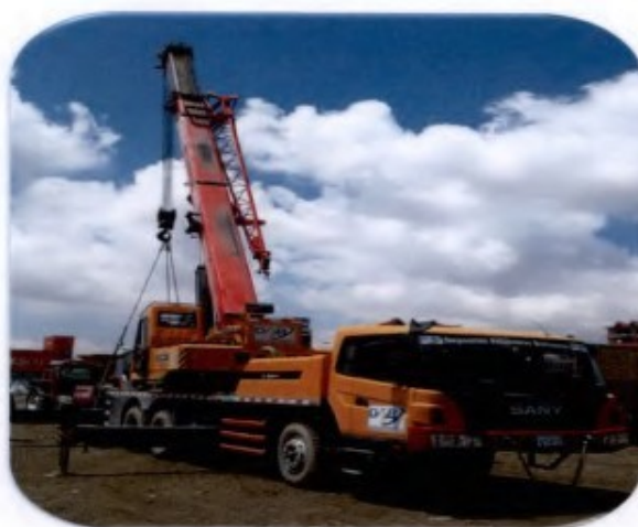
Grúa de 30 Toneladas (TN)
